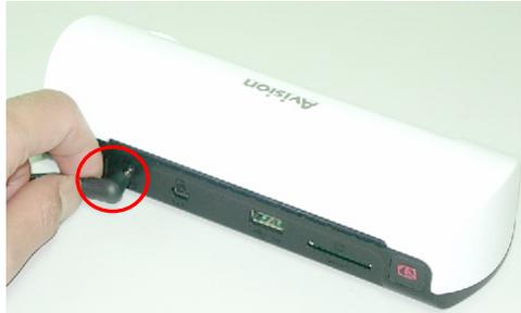
2. Verbinden Sie das Netzteil mit einer Steckdose. Warten Sie, bis die Anzeigeleuchte des Scanners aufhört zu blinken und dauerhaft leuchtet, was bedeutet, dass der Scanner betriebsbereit ist.
