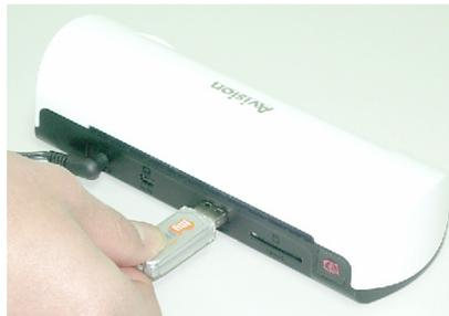
Schließen Sie eine Flashdisk am Flashdisk Steckplatz an.
