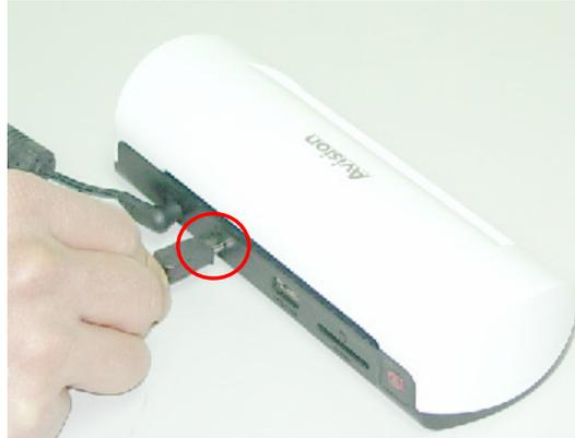
5. Schalten Sie Ihren PC ein und verbinden Sie anschließend das größere Ende des USB Kabels mit einem USB Anschluss Ihres Computers.
