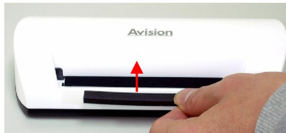
5. Das Reinigungswerkzeug wird automatisch in die Zuführung gezogen und der Reinigungsvorgang beginnt.
