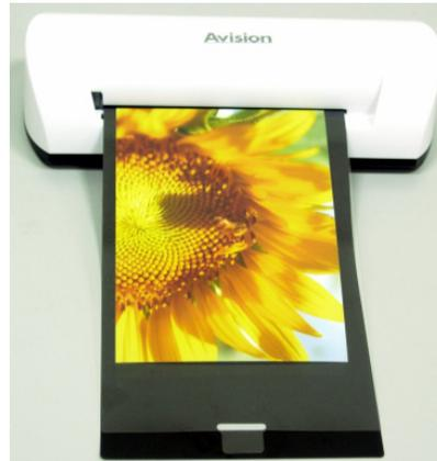
2. Legen Sie die zu scannende Seite nach oben zeigend in der korrekten Ausrichtung ein und bringen Sie die linke Ecke des Originals an der linken Ecke des Dokumenteneinzugs an.
